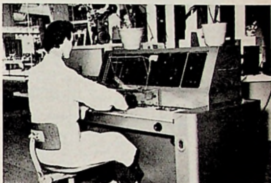
DOOR AVO VOOR AMROH GEBOUWDE MEETTAFEL, voor het controleren van de AVO meters
